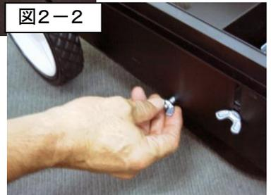
2. 十分に緩めたら、ハンドルを回転させます(図3)。図4の位置までハンドルを回転させたら、もう一度ネジを締めます。
