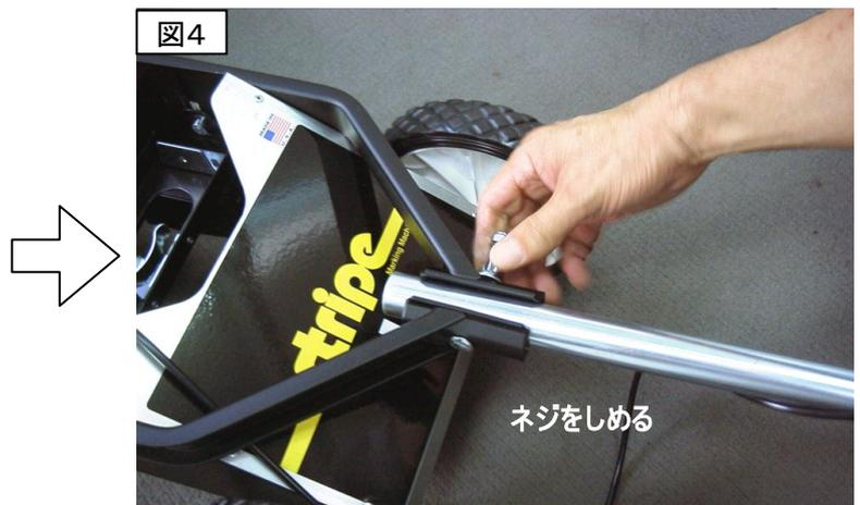
3. ネジを締めたら図5のようにハンドルを起こします(図5)。固定用ネジを締めます(図6)
